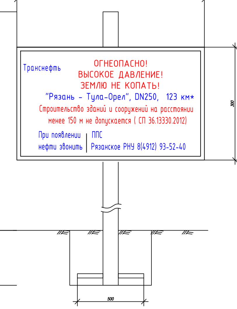
Щит - указатель с предупреждающим знаком "Огнеопасно! Высокое давление! Землю не копать" Е.11
